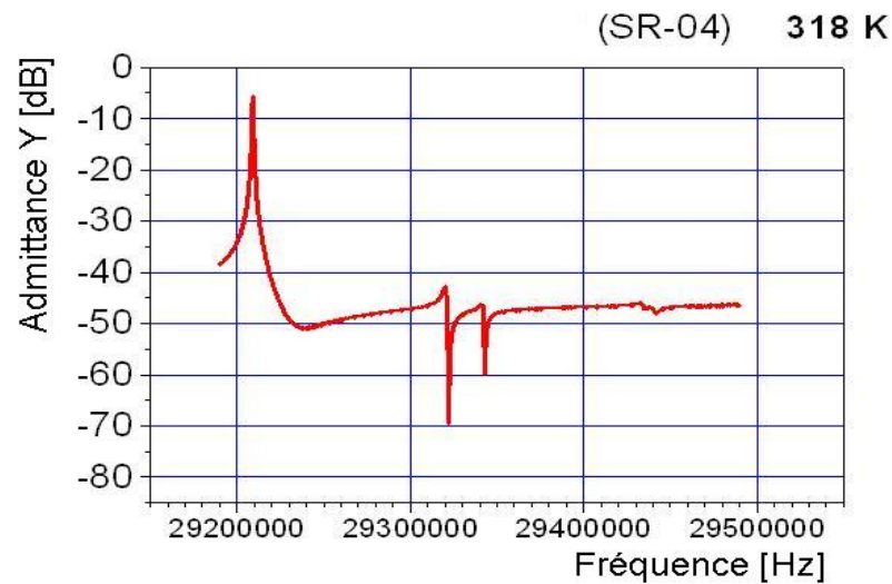
Figure 4.33. Spectre du résonateur QT strip no. SR-04 enregistré à 318 K.
