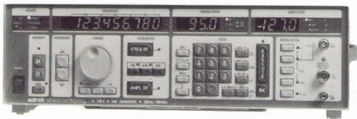
Destiné aux mesures spécifiques des équipements de Radiocommunication et de Radiodiffusion, le 730 A constitue en outre un appareil d'usage général particulièrement souple du fait de sa résolution de fréquence et de ses nombreuses fonctions.
